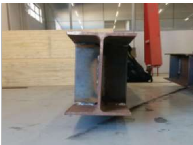
Figura 8. Flambagem da viga VE2
