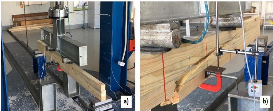
Figura 7. Ensaio de flexão: (a) Ensaio de Flexão Estática à Quatro Pontos; (b) viga rompida após ensaio de flexão estática a Quatro Pontos
