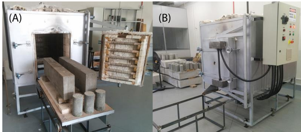
Figura 3. Processo de aquecimento: (a) Posicionamento dos elementos, (b) Mufla em operação
