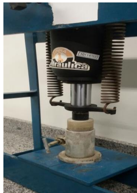
Figura 4 – Aplicação da pressão nos corpos de prova.
